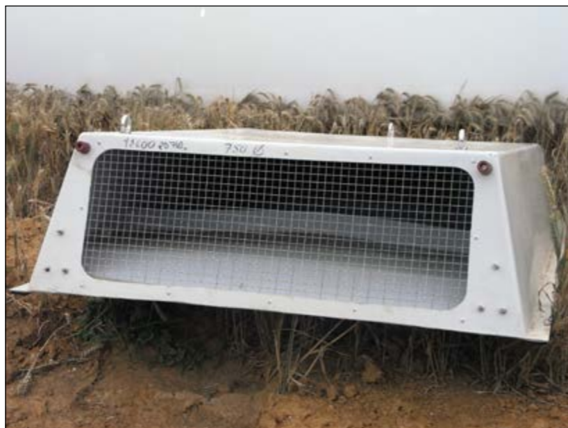
Photo 28 : Exemple de protection pour éviter l'intrusion de chiroptères
